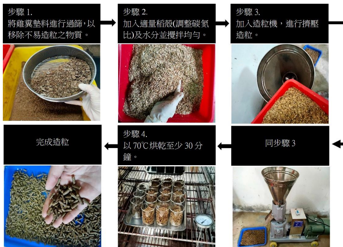
圖 2、自製雞糞加工肥料之製作流程
