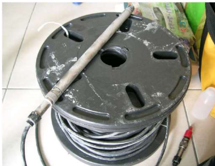
圖 5 美國 In-situ Troll-200 水壓、水溫及導電度自記測棒。(陳文福等 2017)
