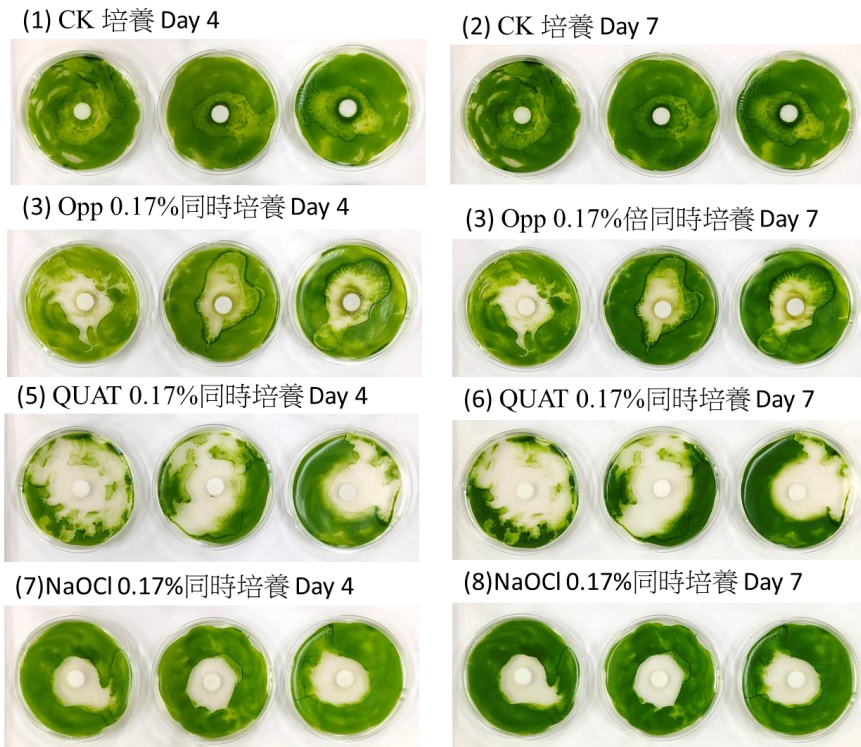
圖 14 培養基培養藻液處理鄰苯甲基對氯酚、氯化正烷二甲苯甲基銨及漂白水對小球藻抑制生長試驗，藻液與殺菌劑 0.17%同時培養，按每平方公尺施用 50 毫升藥液的劑量，每個處理均在濾紙錠滴加 119 ul 殺菌劑，圖中為 3 次重複試驗的結果。
