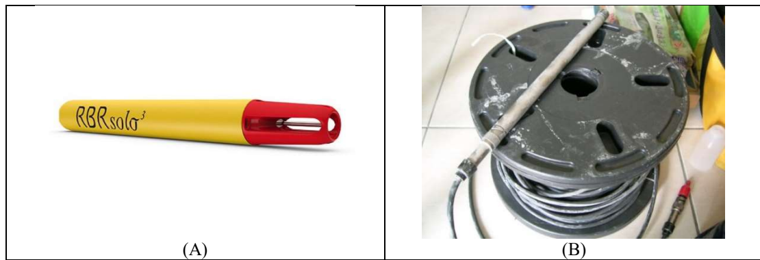
圖 5 溫度及水壓量測儀器 (A)加拿大 RBR 溫度測棒；(B)美國 In-situ Troll 水壓自記測棒
