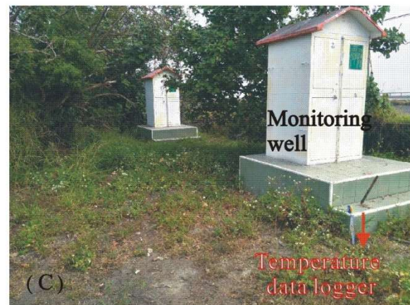
圖 3 (A) 第 28 號井的 Google 衛星影像； (B) 使用衛星影像判別地表覆蓋的類型，並皆有人員實地查證； (C) 觀測井之照片，現地可見裸露土壤和樹林，紅色箭頭指出溫度計所埋設的位置。
