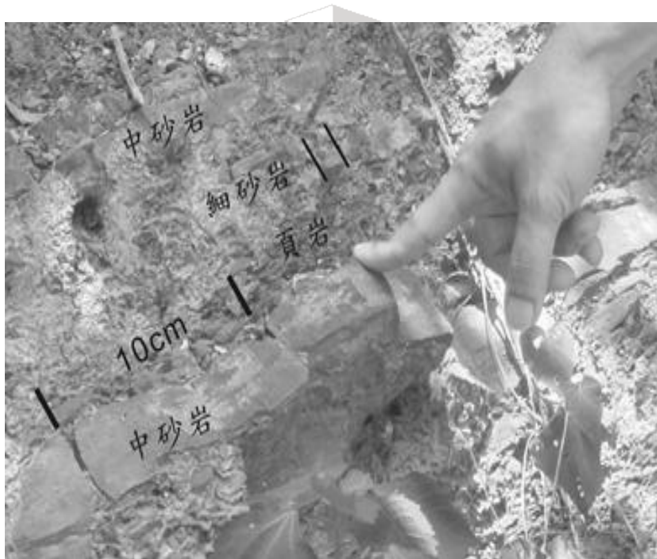
圖2.2.8 石門層砂頁岩之破裂孔隙
