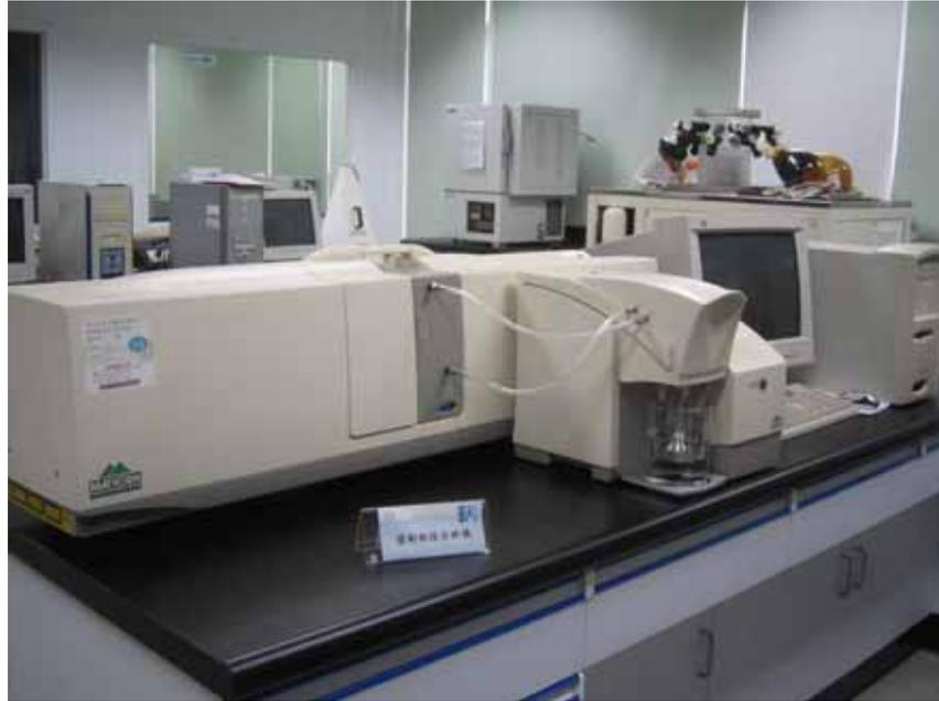
圖 2-1 Mastersizer2000 雷射光散射法粒徑偵測儀
