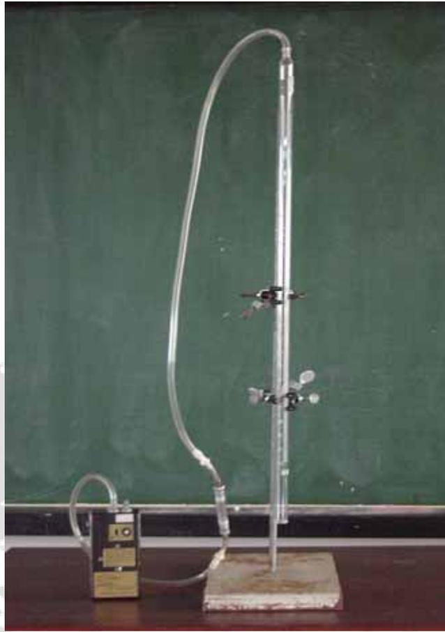
圖 2 流率校正設備組合圖
