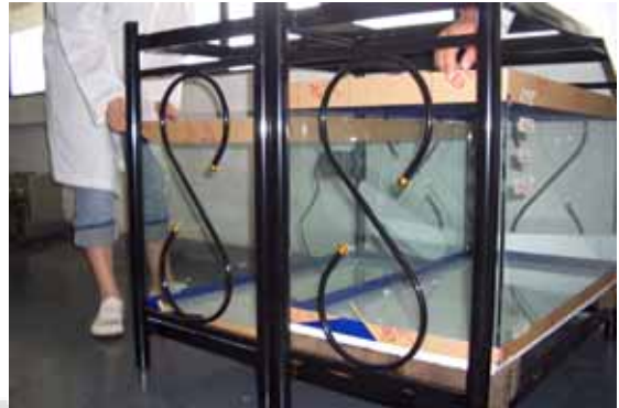
圖一 底泥環境模擬實驗槽之槽身
