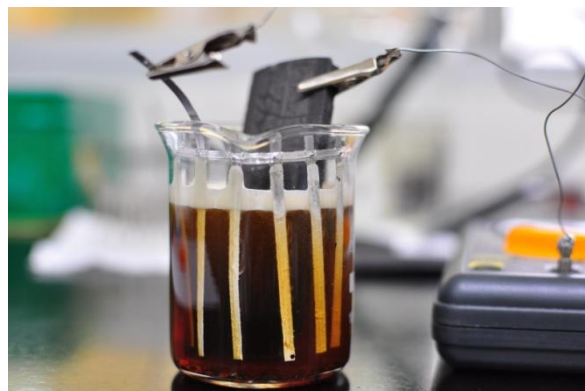
圖5b 備長碳跟鎂片測量情形
