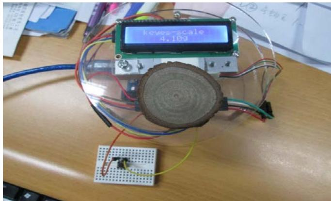
圖 5.3:模擬物品進行系統雛型測試
