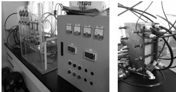
(A) EDR試驗機組 (B) 電透析器 圖2 倒極電透析（EDR）試驗機組
