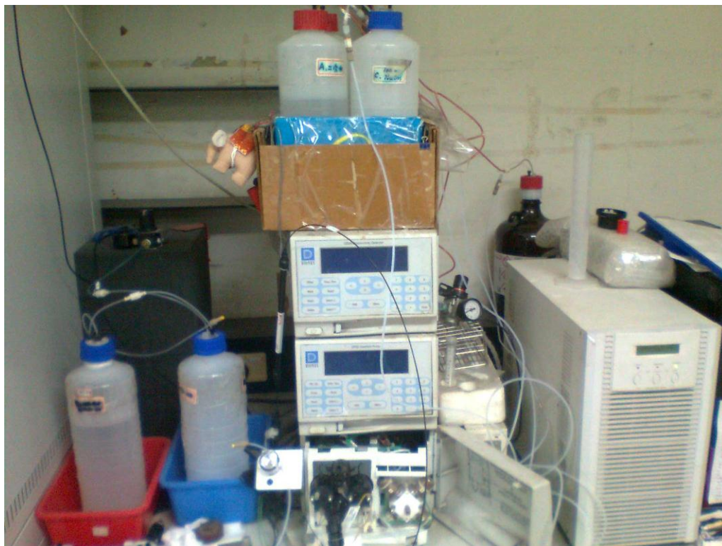
Fig. 3.5 羧酸分析儀 Dionex DX-600
