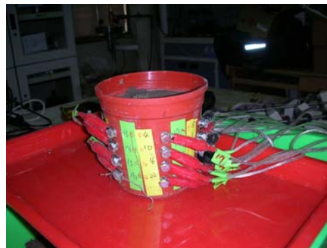
圖 6 盆摘中地電阻探針設置圖
