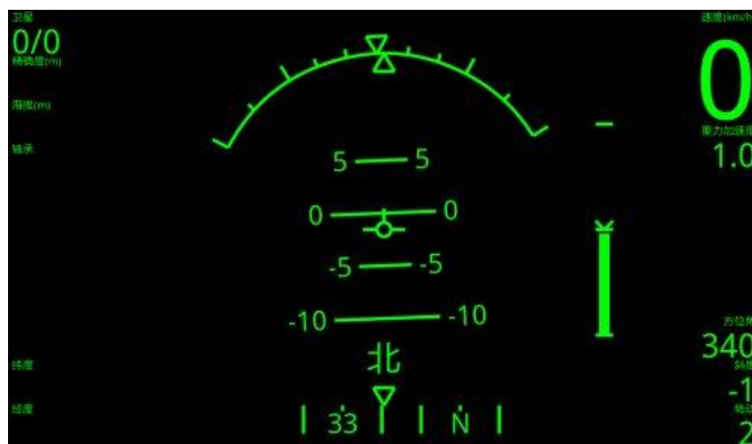
圖 2-10 水平陀螺儀，常見於飛機顯示裝置
