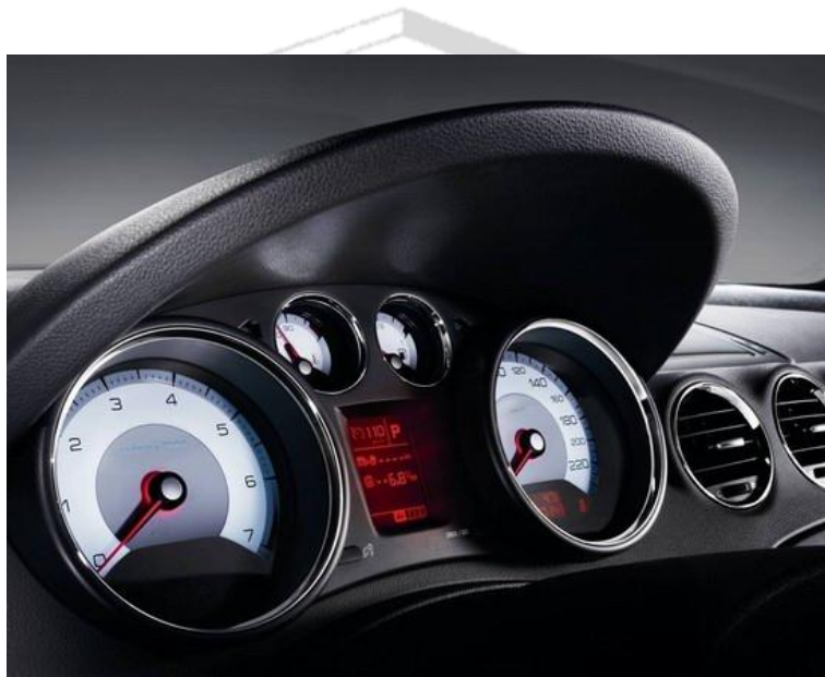
圖 2-6 傳統類比顯示與 LCD 共同應用在汽車儀表設計
