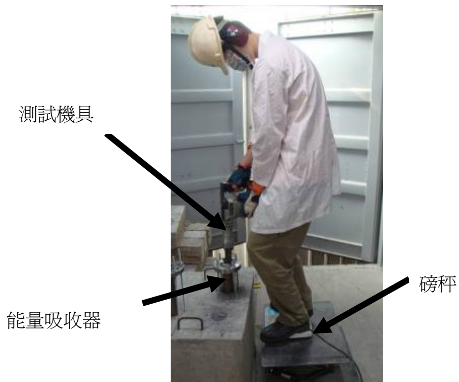
圖 三-7 混凝土破壞機操作平台
