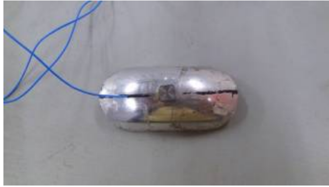
圖 二-2 加速規適合於托架
