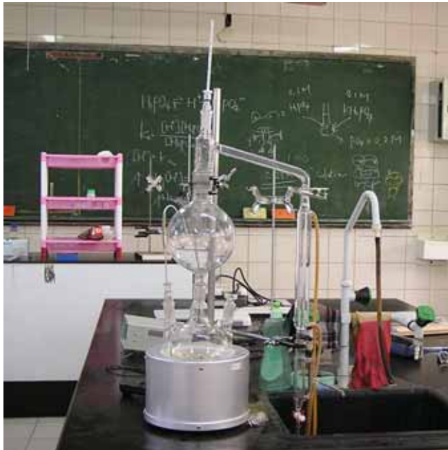
圖 1: 實驗中所使用的水蒸氣蒸餾裝置。
