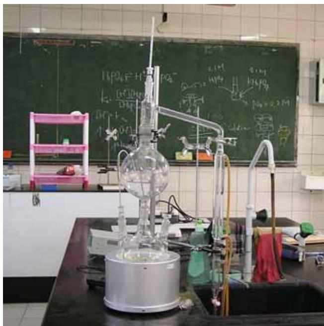
圖 1：實驗中所使用的水蒸氣蒸餾裝置。
