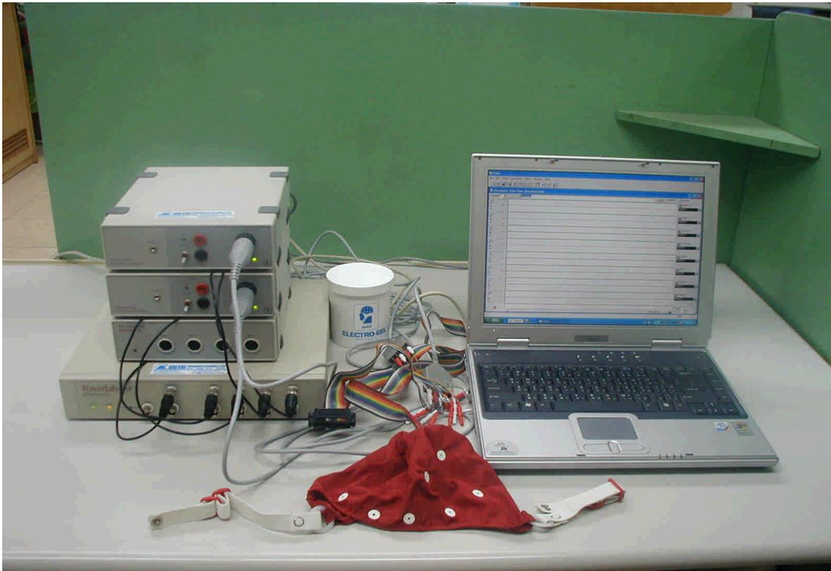
圖四 ADInstruments – PowerLab 電生理信號量測儀
