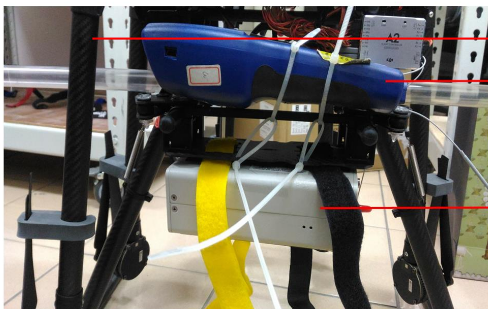
Fig. 9. UAVs 搭載粉塵質量濃度計數器及二氧化碳監測儀
