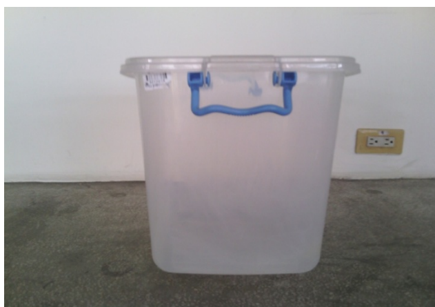
圖 2. 沉浸式 MBR 槽體
