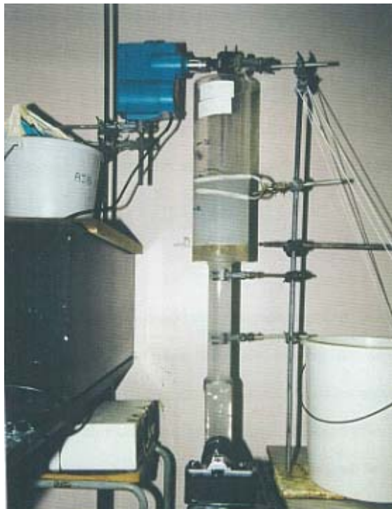
圖 2 膠羽拍攝相機影像分析系統
