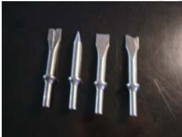
圖十三 鑿刀由左至右分別為扁平凹槽、尖、扁平、V形
