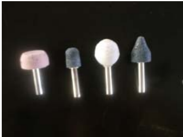
圖十二 研磨輪由左至右分別為長滾筒形、短滾筒形、球形、滾筒尖頭
