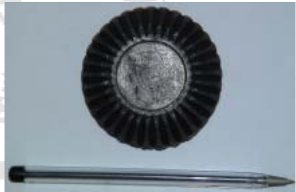
圖 8 實驗鍛造後之傘齒輪
